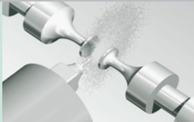
Zerstäuben von Pulverlack im Ultraschallstehwellenfeld
