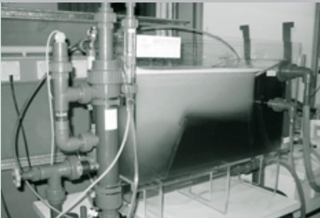
Versuchs-Flotationsanlage nach dem Druckentspannungsprinzip
