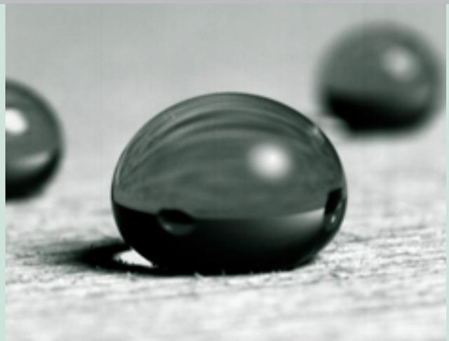
Wassertropfen auf einer mit Nanopartikeln behandelten Holzoberfläche; technisches Produkt der BASF, welches den „Lotus-Effekt“ nachstellt (Foto: BASF)
