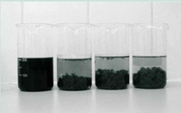
Untersuchungsreihe zur Flockung von Abwasserinhaltsstoffen aus Deponiesickerwasser
