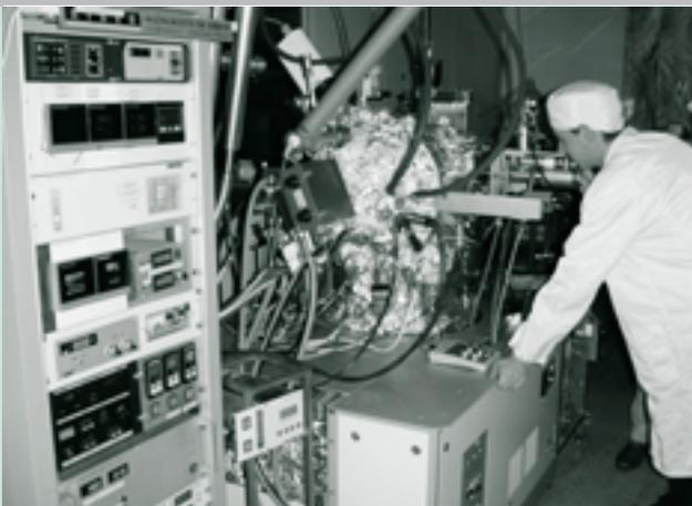
Herstellung von Halbleiterschichten im Ultra-Hochvakuum (Molekularstrahlepitaxie)
