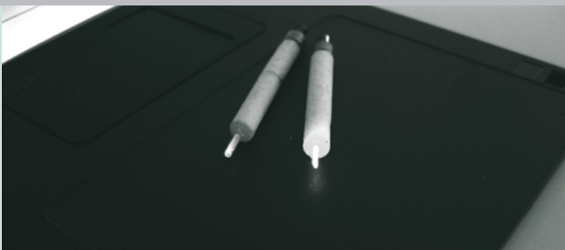
Bild 1: Foto zweier einkristalliner langlebiger Leuchtstoffe. Die Proben sind bereits an Styropor®-Probenhalter geklebt. Die Aufnahmen entstanden in normalem Tageslicht nach 10-minütiger Anregung mit Sonnenlicht
