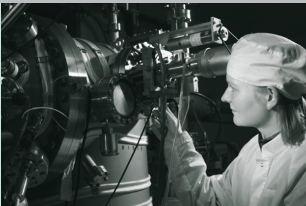
Kontrolle des MBE-Wachstums einer kubischer Gruppe III - Nitrid Schicht
