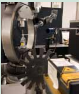
Optische Laue-Aufnahmen an Photonischen Kristallen
