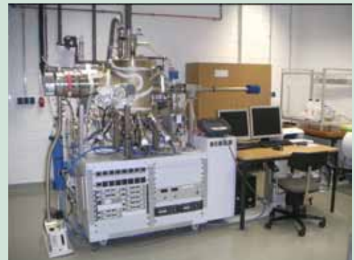
Anlage zur Molekularstrahlepitaxie von Zinkoxid
