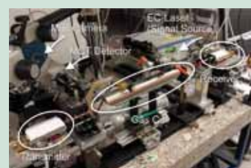
MIR-Spektroskopie mit Wellenlängenkonvertern
