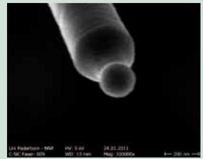
Siliziumkarbid-Nanokugel auf Siliziumkarbid-nanodraht
