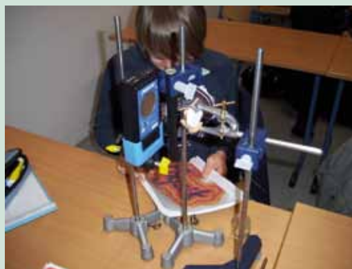
Interesse fördernder Unterricht: Füllstandsmessung mit Isotopenmesstechnik
