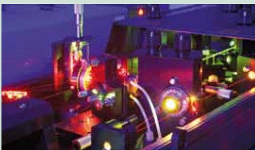
Durchstimmbarer ps-Laser für die kohärente Spektroskopie
