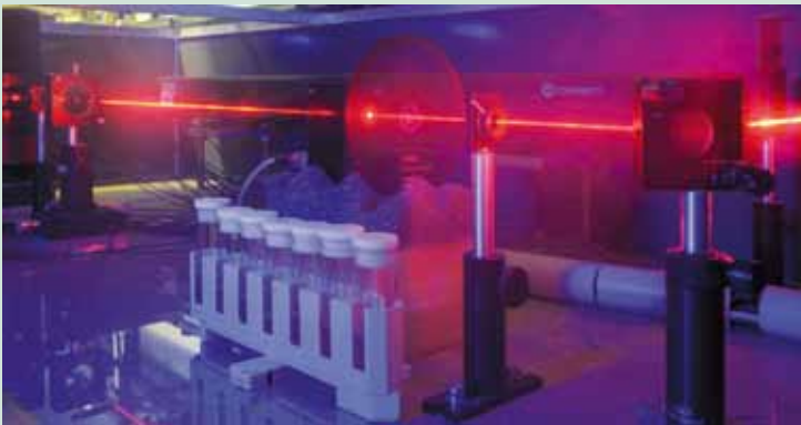
Rotierende Sektorblenden modulieren einen eintreffenden Laserstrahl
