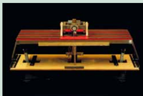
Stabilometer zur Analyse der Gleichgewichtsregulation, eingesetzt im Rahmen verschiedener Untersuchungen zu motorischen Transfereffekten
