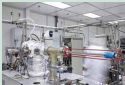
MBE-Anlage für Nitride
