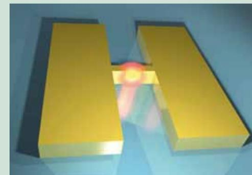
Auf maximale Intensität optimierte plasmonische Nanoantenne
