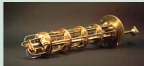
Eigenentwicklung eines Höchstfrequenzkryosystems für elektrisch detektierte magnetische Resonanz
