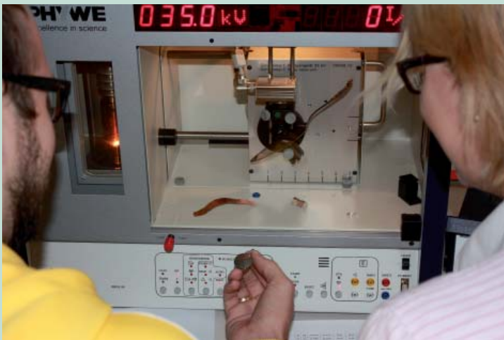
Analyse der Legierungselemente von Schmuck und Tafelsilber mit energiedispersiver Röntgenspektroskopie im Schülerlabor
