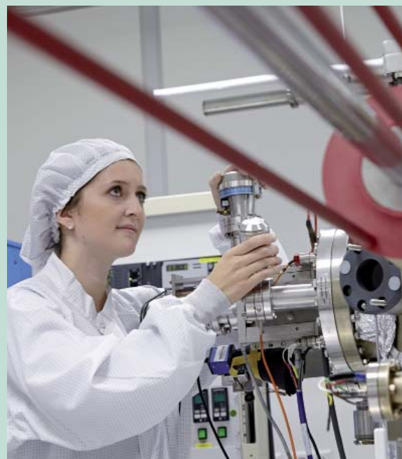
Molekularstrahlepitaxie zur Herstellung von GaN
