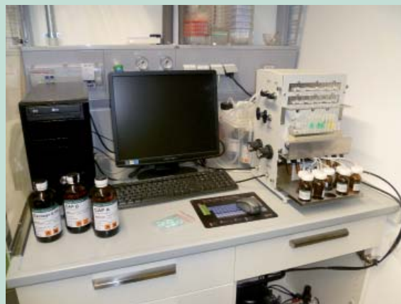
Am DNA/RNA-Synthesizer werden mittels automatisierter Methodik kurze Nucleinsäuren (Oligonucleotide) mit modifizierten Strukturen hergestellt.
