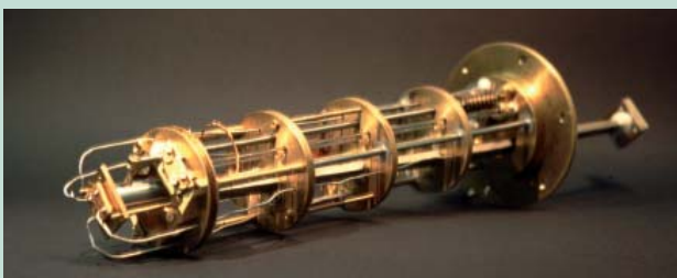
Eigenentwicklung eines Höchstfrequenzkryosystems für elektrisch detektierte magnetische Resonanz
