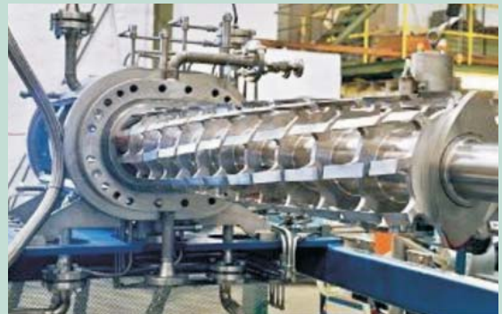
Hochviskose Prozesse in Knetern: Mischwerkzeug eines Kneters
