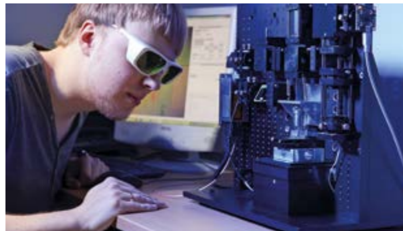
Lithographie mittels Laser-Direktbelichtung
