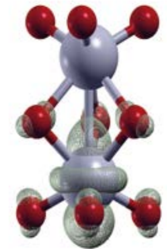
Ladungsverteilung des Polarons an einem Nb-Substitutionsatom in Lithiumniobat
