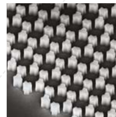
Rasterelektronenmikroskopie-Aufnahme einer nanostrukturierten Siliziumoberfläche
