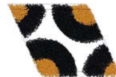
Simulation (Ausschnitt) von Schwefel in den Poren eines nanoporösen Kohlenstoff-Materials
