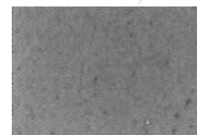
Großflächig selbstorganisierte Anordnung von 17 nm großen Poren
